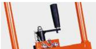
SYSTÈME DE CONTRÔLE DE PROFONDEUR MANUEL
