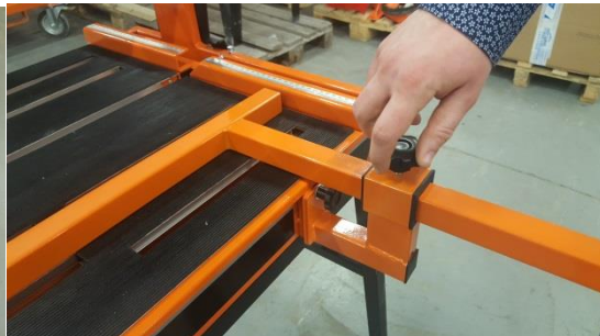
Puis verrouiller avec les boutons moletés
