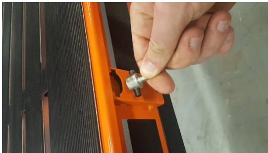
Engager les 2 axes filetés et goupillés
