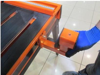
Mettre en place les 2 supports de guide et les verrouiller à l'aide des boutons moletés
