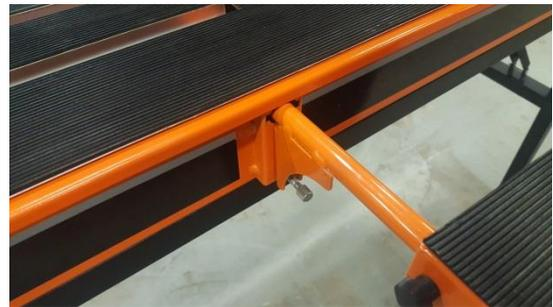
Effectuer une rotation des axes de 90° pour verrouiller
