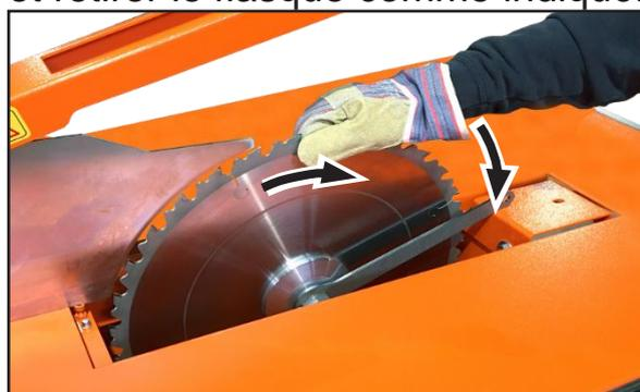
6 - Monter la lame et serrer avec la clé fournie
