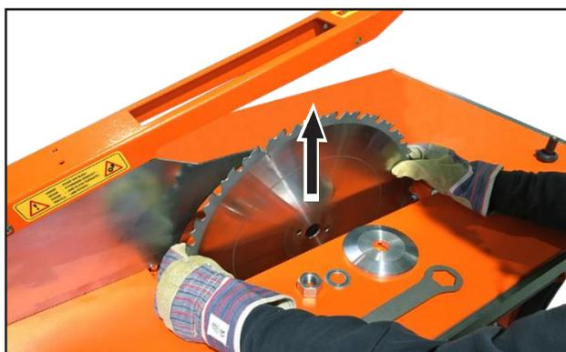
5 - L'écrou a un pas à gauche. Retirer la lame
