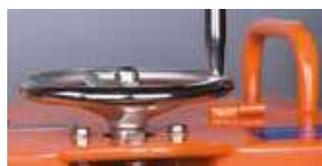
RÉGLAGE DE LA PROFONDEUR DE COUPE PAR VOLANT ET VIS SANS FIN
