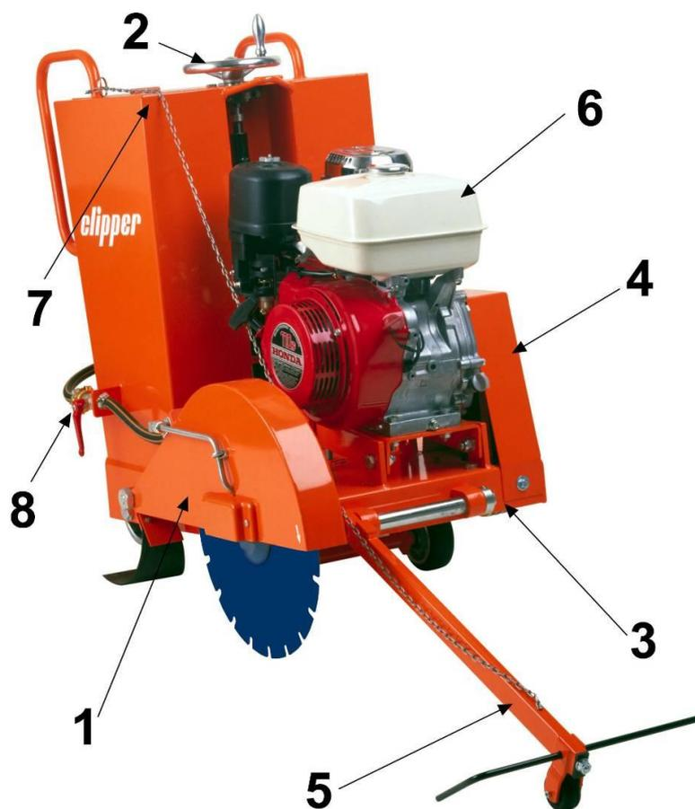
Faite d'acier profilé soudé, la CS1 est à la fois stable lors de la coupe et facilement transportable.
