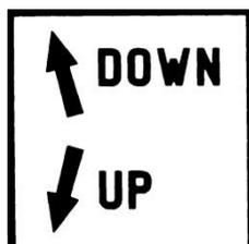
La rotation du volant dans le sens indiqué monte (UP) ou descend (DOWN) la lame
