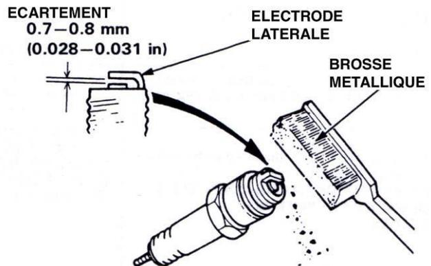
type à fil. Si nécessaire, ajustez l'écartement en recourbant l'électrode latérale.
