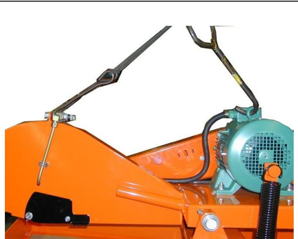
Der Kopf der Maschine ist in der Wasserwanne der Maschine geliefert. Um den Kopf wieder aufzubauen brauchen Sie eine Brücke, die 100kg tragen kann.
