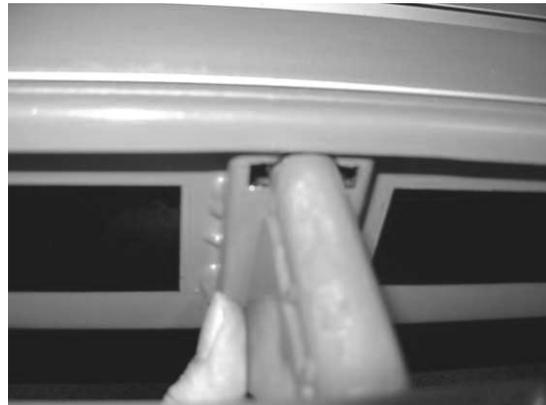
Effectuer une rotation des axes de 90° pour verrouiller
