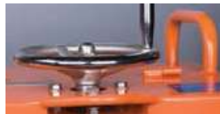
HANDRAD FÜR TIEFENEINSTELLUNG MIT SCHNITTIEFENANZEIGER.
