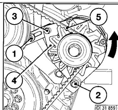
Pour changer cette courroie, desserrez les vis (1), (2) et (3). Déplacez l'alternateur (4) dans la direction indiquée. Enlevez l'ancienne courroie et montez une nouvelle. Puis déplacez l'alternateur dans la direction opposée jusqu'à obtention de la tension de courroie suffisante. Resserrez alors les vis (1), (2) et (3).
