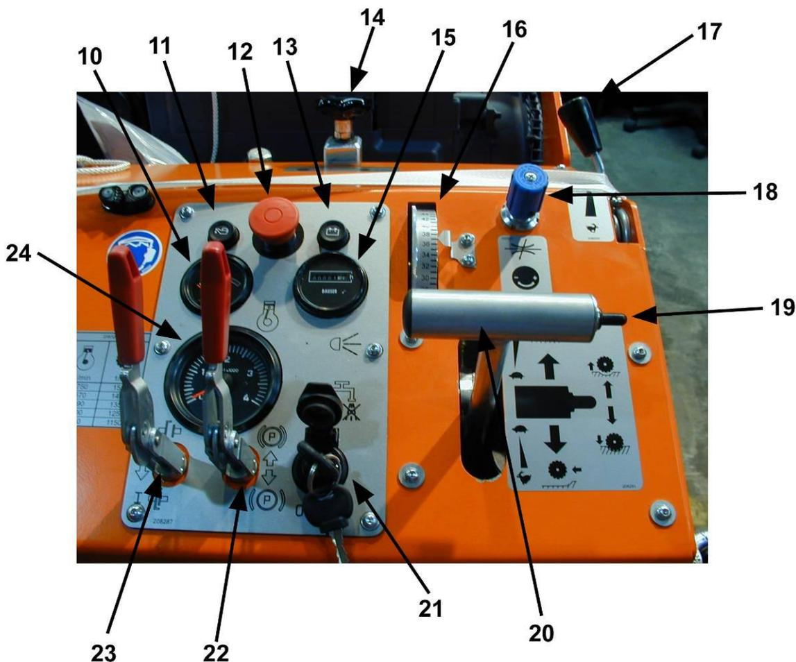
Deux témoins lumineux indiquent la pression d'huile d'une part (11) et la charge de la batterie d'autre part (13). Le bouton d'arrêt d'urgence (12) est situé à portée de l'opérateur. Un thermomètre donne la température du moteur (10). Le compteur horaire (15) permet de mesurer le temps d'utilisation de la machine.
