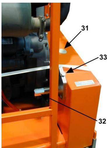
Après une heure de fonctionnement, les courroies s'échauffent et se détendent. Il faut donc les retendre. Contrôlez régulièrement la tension des courroies, notamment à la fin de chaque semaine et après une panne ou un incident. Pour cela, retirez le bouchon (31) et appuyez avec une force moyenne sur les courroies. Si elles se déplacent de l'épaisseur d'une courroie, la tension est suffisante.
