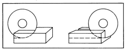
La tête de coupe de la machine est verrouillée à une profondeur fixe et est poussé vers le matériau comme l'indique le croquis.
