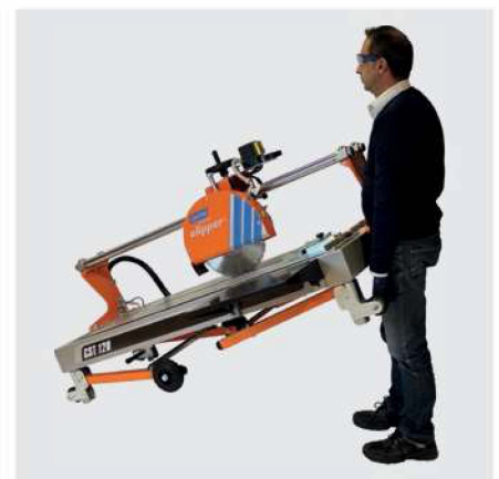
LEICHTER TRANSPORT DANK EINKLAPPBARER FÜÙE UND TRANSPORTRÄDER.
