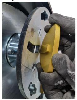
• Schieben Sie das Werkzeug durch das Loch von der Mitte nach außen in die Werkzeughalterung, bis es einrastet.
