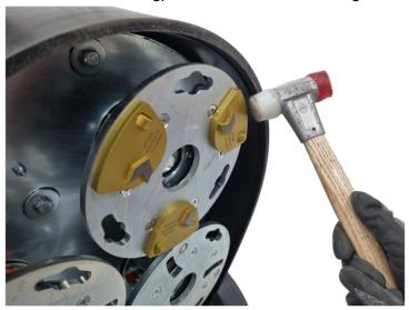
• Setzen Sie die Werkzeuge ein. Positionieren Sie den Schwalbenschwanz jedes Werkzeugs in der Innenseite des Befestigungslochs. Ein Magnet sorgt dafür, dass die Wings bis zur Verrieglung in ihrer Position gehalten werden.
