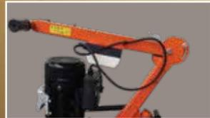
VERSTELLBARER FÜHRUNGSARM FÜR ANWENDUNG UND TRANSPORT
