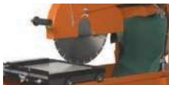
SCHUTZHAUBE BLEIBT IMMER WAAGRECHT ZUM ROLLTISCH
