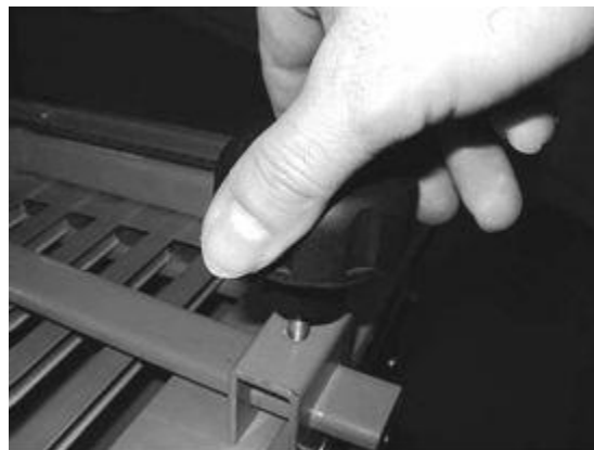
Die Schnittführung in der gewünschten Stellung arretieren.
