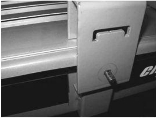
Die 2 Halter der Längsschnittführung auf die Bolzen setzen und mit der Rändelschraube sichern
