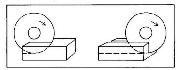
Schneidkopf mit dem Griff am Sägeblattgehäuse oder mittels Fußpedal oder Handkurbel auf die gewünschte Schnitttiefe absenken, bis dieser max. 3 mm unter der Tischoberkante steht (für volle Schnitttiefe).
