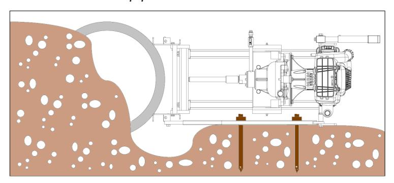
Poser la machine au sol perpendiculairement par rapport à l'axe du tuyau, la fixer avec les deux piquets de terre, de telle sorte que l'embase du tube adhère bien au tuyau avec ses deux points d'appui (effet de centrage).
