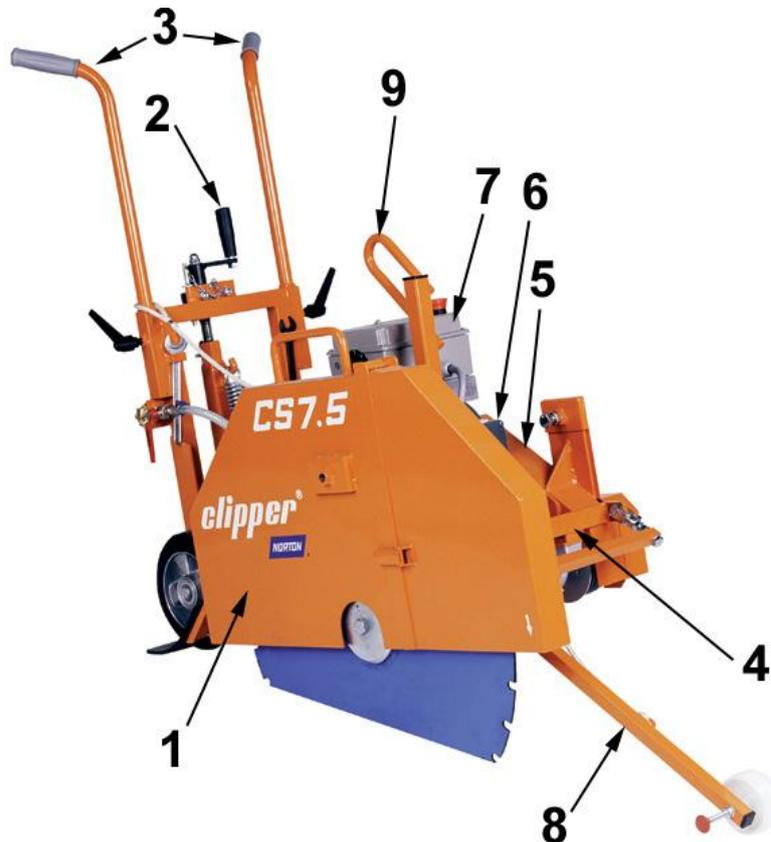
Aus verwindungssteifem geschweißtem Stahl hergestellt, ist der CS7,5E 800 sowohl stabil beim Schneiden als auch einfach zu transportieren.
