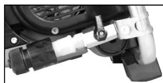
Wasserzufuhr verschlossen (Ventilhebel quer)
