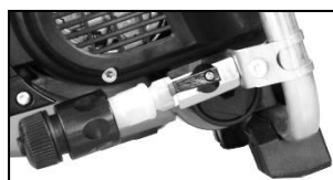
Wasserzufuhr geöffnet (Ventilhebel parallel)
