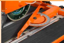
Tisch mit Antirutschbeschichtung / Winkelschnittführung
