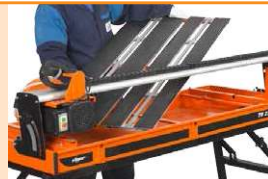
Einfaches Entfernen des Auflagetisches
