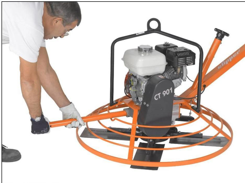
Pour transporter la machine à l'aide d'une grue, veuillez n'utiliser que l'anneau de levage prévu à cet effet. Assurez-vous de la fixation solide du dispositif de levage à la machine.
