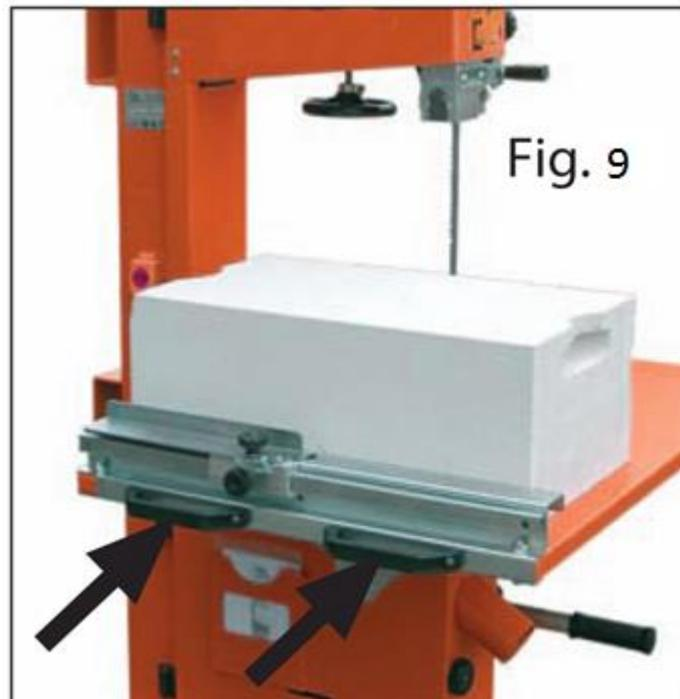
Après la coupe, s'assurer que la lame est arrêté avant de retirer la pièce coupée (toujours aller en fin de course avec le plateau mobile, de façon à obtenir l'arrêt automatique de la lame).
