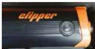
FACILITÉ D'ACCÈS AUX BALAIS DU MOTEUR
