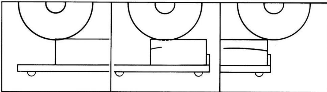
Le principe de coupe multiple consiste à pratiquer des passes successives peu profondes en déplaçant le matériau avec le chariot mobile vers l'arrière et vers l'avant sous le disque qui décrit à ce moment des arcs de coupe (voir croquis).
