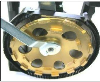
Mit dem Stiftlochschlüssel kann die Mitnahmemutter gelöst werden. Danach kann die montierte Schleifscheibe entfernt bzw. die neue montiert werden.
