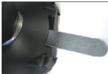
Nun kann durch die Öffnung an der Schutzhaube mit dem im Lieferumfang enthaltenen Maulschlüssel SW 32 die Flanschscheibe zwischen Getriebe und Schleifscheibe gehalten werden.
