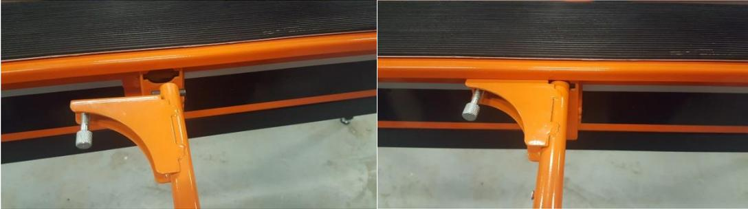
Die beiden Bolzen einsetzen
