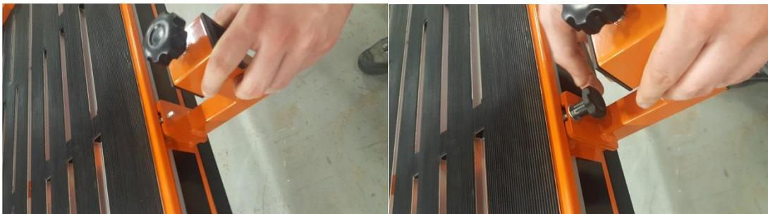
Die beiden Aufnahmen für die Führung auf die Bolzen setzen und mit den Rändelknöpfen sichern
