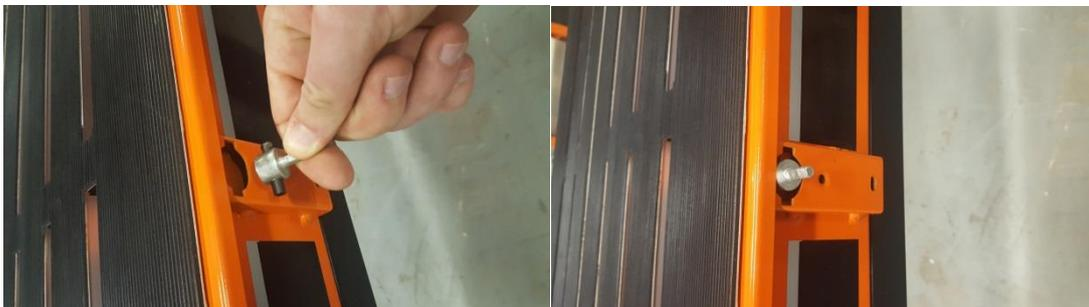
Die beiden Bolzen in die jeweiligen Öffnungen schieben Um 90° drehen
