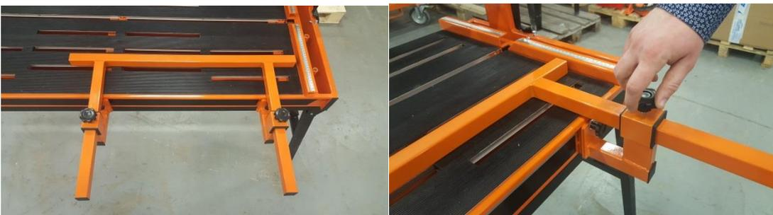
Die Führung in die beiden Aufnahmen schieben Mit den Rändelknöpfen arretieren
