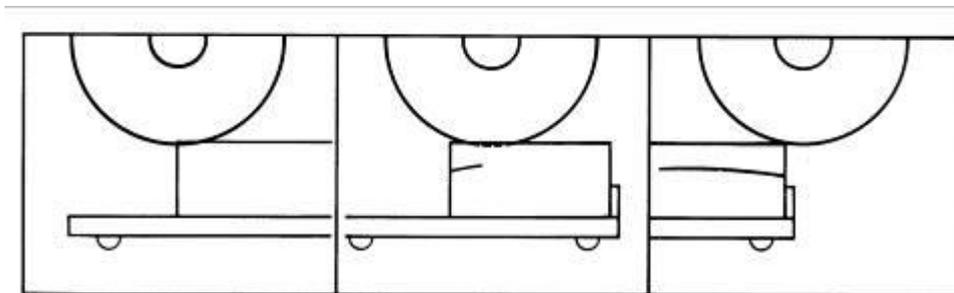
Le principe de coupe multiple consiste à pratiquer des passes successives peu profondes en déplaçant le matériau avec le chariot mobile vers l'arrière et vers l'avant sous le disque qui décrit à ce moment des arcs de coupe (voir croquis).
